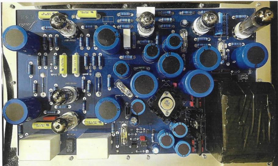
Il circuito del pre con, a sinistra, la fila verticale delle tre valvole ECC83 e, in alto a destra, quella orizzontale costituita da una EL84, una EF86 e una ECC82.
