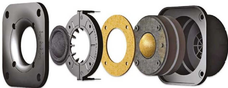
Il tweeter ha la cupola morbida da un pollice ed una piccola cavità alle spalle della cupola in cui si fa uso di due tipi di materiale assorbente.
