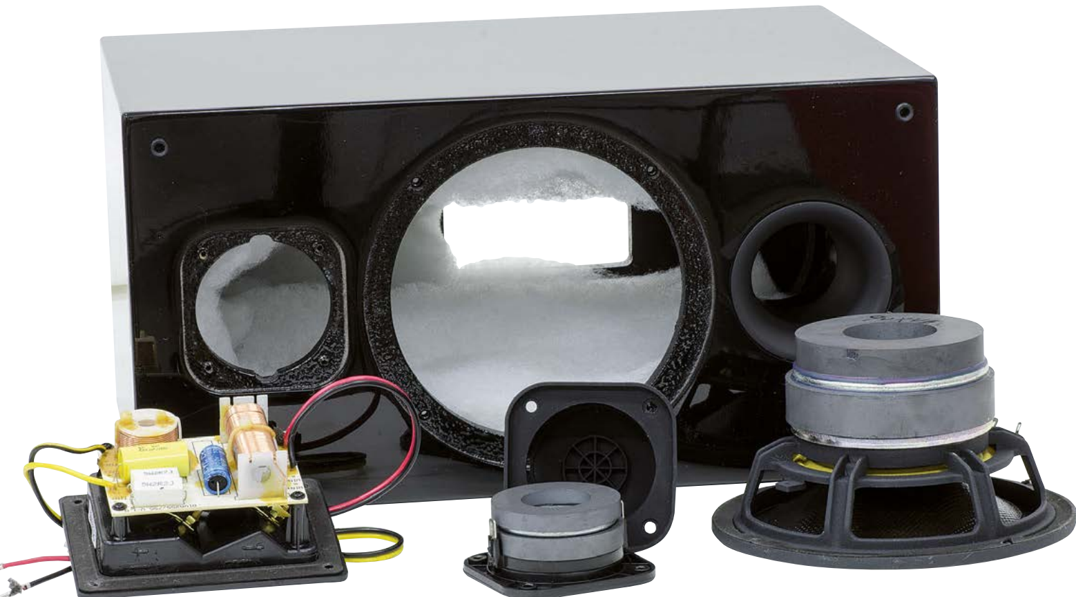
Il diffusore completamente smontato. Notiamo lo stampato del filtro crossover montato a ridosso della vaschetta portacontatti, il guscio di gomma che supporta il tweeter e la dotazione di un secondo anello di ferrite sia sul woofer che sul tweeter.
