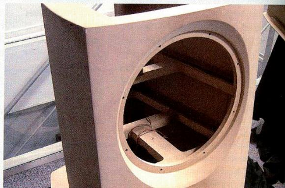
Vue de l'ébénisterie de grave d'une Grande Utopia EM avec quantité de renforts et cintrages internes positionnés après mesures par cartographie vibratoire. Le galbe des faces latérales est formé par usinage de plaques de médium de 60 mm.
