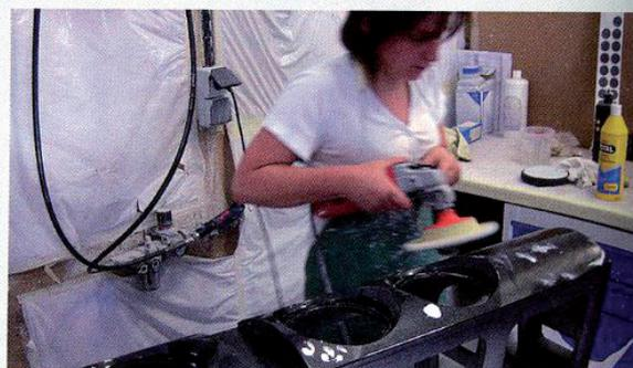
Une fois peintes et avant assemblage final, les ébénisteries passent au ponçage de finition effectué à la ponceuse pneumatique et au polish de qualité carrosserie automobile.
