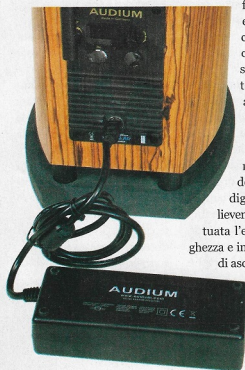
Ogni diffusore è dotato di alimentatore dedicato switching da 36VDC e 4,2A max con cavo di connessione 4 poli con le coppie in parallelo: una riserva di potenza al di sopra di quella richiesta dal sistema, anche alla massime richieste di energia.
