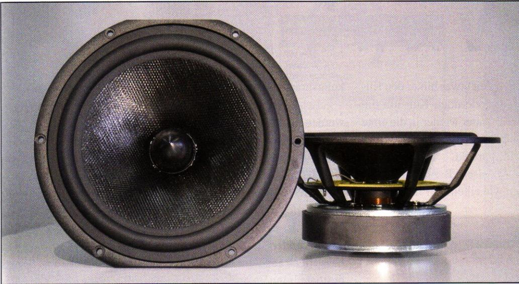
Ungleiches Duo: Der 9-Zöller im Sockel der Box ist mit superkräftigem Magneten und großer Schwingspule ein reiner Subbass, dessen Korb mit hinterlüfteter Zentrierung auf Kompressionsarmut hin optimiert wurde. Der 4-Zoll-Mittelhochtoner ist dagegen filigran mit einem kurzen Schwirrkonus und einer metallenen Staubschutzkalotte – nicht etwa ein Phaseplug.
