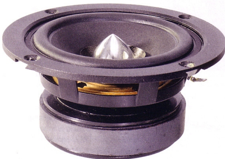
Der 10-cm-Konus mit durchlüfteter Zentrierung und leichter Pappmembran sieht aus wie ein Mitteltöner. Die Phaseplug-ähnliche Kalotte und der Schwirrkonus sorgen jedoch für exzellente Höhen.
