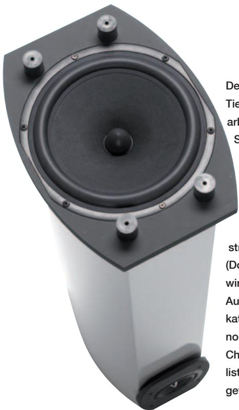
Der elfzöllige Tieftontreiber arbeitet im Sockel nach unten hin gegen eine (hier abgenommene) Bodenplatte strahlend (Downfiring). Er wird nach Audium-Spezifikationen vom norwegischen Chassis-Spezialisten Seas gefertigt.
