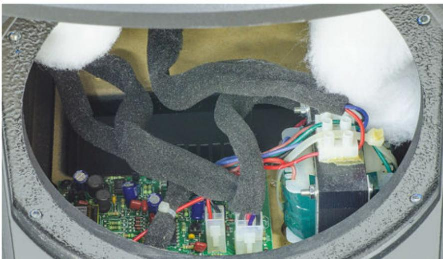
Subito dietro il woofer frontale è collocata la sezione elettrica ed elettronica necessaria al funzionamento della cella Xstat, ovvero il trasformatore-elevatore e l'alimentatore in continua ad alta tensione per la polarizzazione. Tutti i cavi sono accuratamente rivestiti in foam e collocati in modo da impedire l'insorgenza di vibrazioni interne, e terminano in connettori sfilabili ma dal serraggio decisamente tenace.
