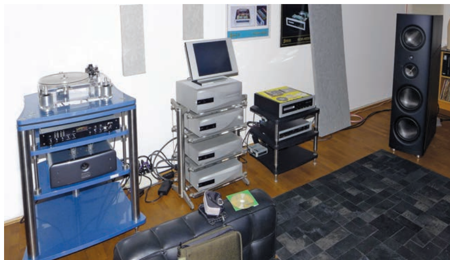
La sorgente digitale Vivaldi di DCS consta di 4 telai (nel rack centrale) con meccanica di lettura CD/SACD, sovracampionatore, DAC e masterclock.
