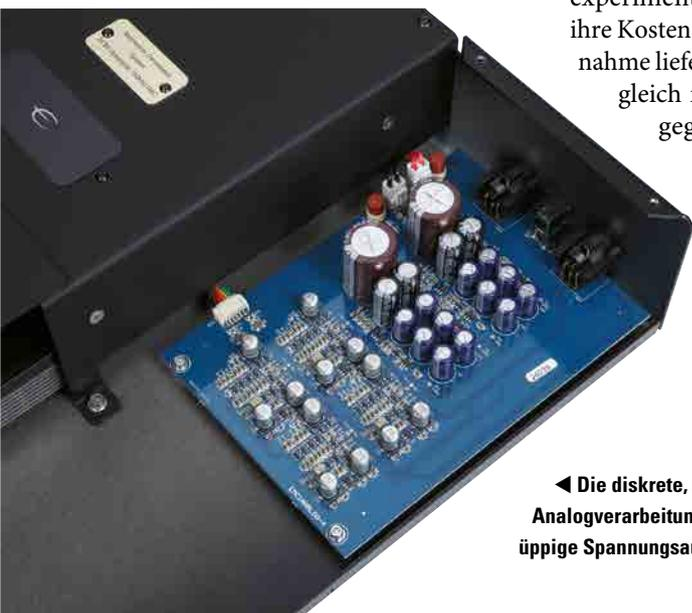
◀ Die diskrete, dennoch aber äußerst kompakte Analogverarbeitung besitzt eine eigene, erstaunlich üppige Spannungsaufbereitung.
