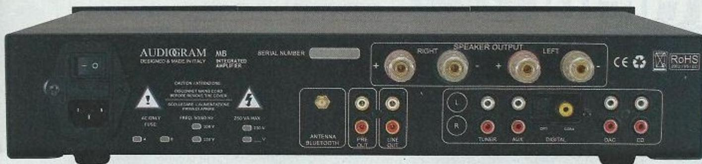
Il pannello posteriore ospita rispettivamente da sinistra verso destra: la vaschetta di alimentazione IEC sormontata dall'interruttore generale; l'antenna bluetooth; la coppia di RCA pre-out e la coppia Line Out; la coppia di input RCA tuner, la coppia RCA input Aux, il connettore toslink ottico, il connettore coassiale digitale SpDif; la coppia RCA Dac e la coppia RCA CD; sopra gli input troviamo i quattro morsetti con serraggio a vite per i diffusori.
